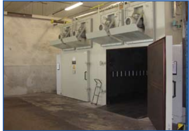
Zwei Hochleistungs-Härteöfen mit modernster Brennertechnik
