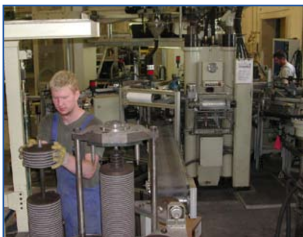
Pressautomat zur Herstellung von Trenn- und Schrappscheiben
