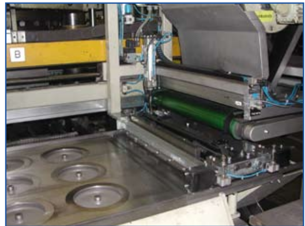
Neu entwickeltes Füllschieberkonzept zur optimalen Mischungsverteilung
